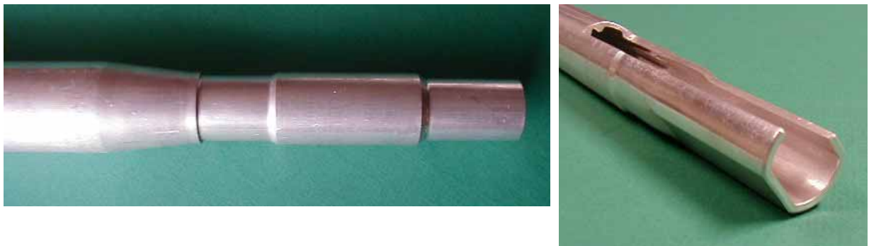
Abbildung 12: umgeformter Hinterschnitt und nicht-rotationssymmetrischer Abschnitt
