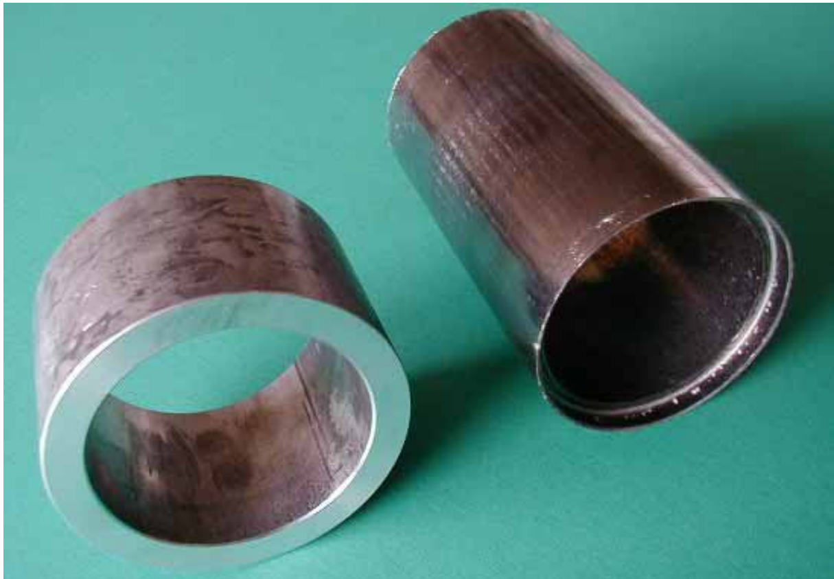
Abbildung 15: Zylinderlaufbuchse aus Aluminium, hergestellt durch Rundkneten (Entwicklungsprojekt der Firmen HMP und PEAK)
