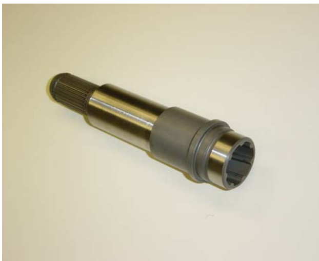
Abb. 15: Anlasserwelle mit schräger Innenverzahnung
