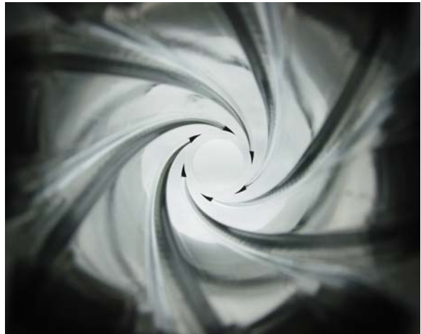
Abb. 14: Welle mit spiralförmigen Kugelbahnen
