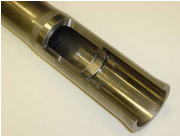
Abb. 13: Polygonale Innenform mit Stufen
